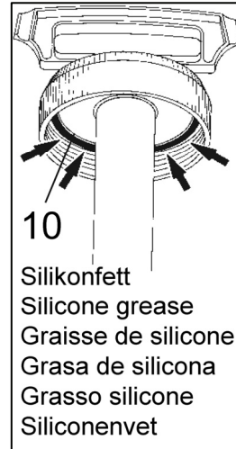
Fig. 10: Zur Behälterabdichtung muss die Deckeldichtung (10) immer gut mit Silikonfett gefettet werden.
